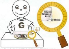
將巨松熟融膠膜完全覆蓋於徽章的背面。 (膠膜的離型紙面需朝上、膠膜面朝下)
